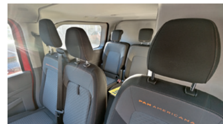
Die L-Wand trennt die Plätze so ab, daß hinter dem Fahrer und neben bzw. hinter den Mitfahrern der zweiten Sitzreihe der Laderaum sicher und schalldämmend abgetrennt ist.
